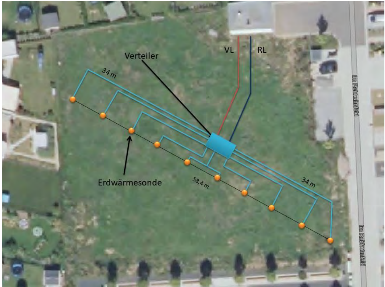
Abbildung 7-4 Potentielle Anordnung der Erdwärmesonden in der untersuchten Liegenschaft
