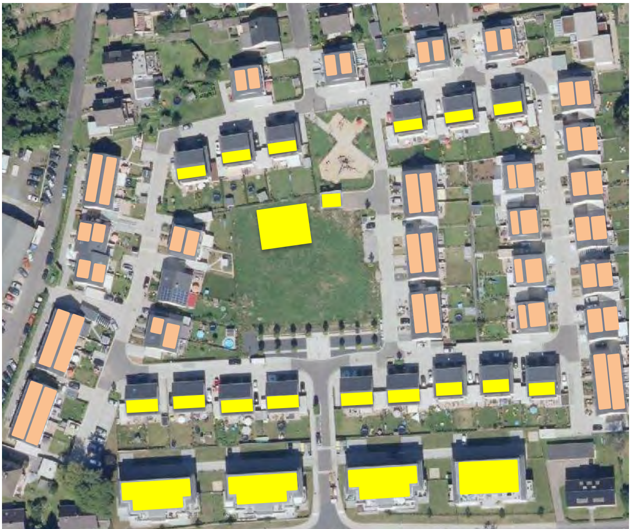
Abbildung 7-2 Nutzbare Dachflächen innerhalb der betrachteten Liegenschaft
