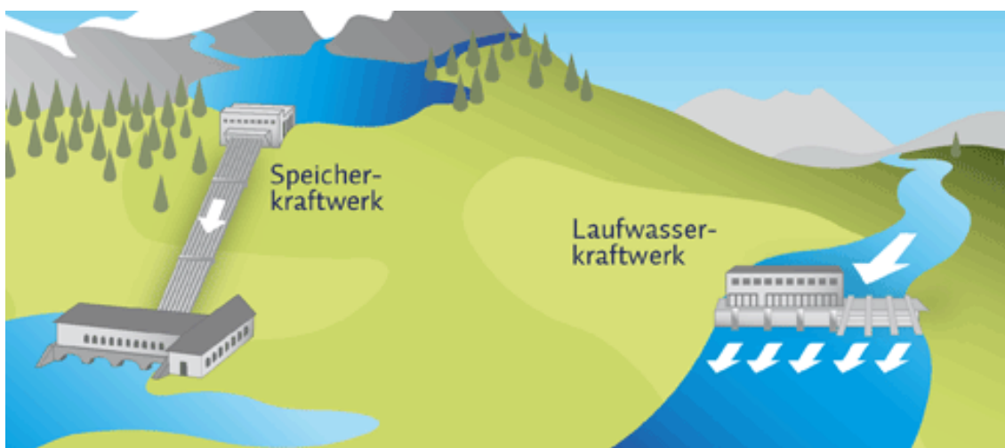
Abbildung 26: Bauarten von Wasserkraftwerken [77]
