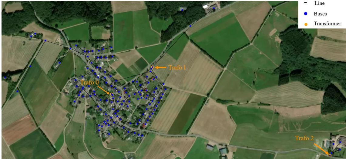
Abbildung 3: Implementiertes Stromnetz in Pandapower [eigene Darstellung]
