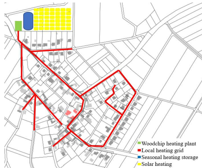
Abbildung 11: Exemplarische Darstellung des Nahwärmenetzes Rodder mit Hackschnitzelheizwerk, Solarthermie und dem saisonalen/täglichen Wärmespeicher [eigene Darstellung]
